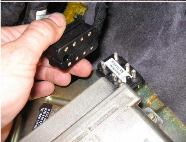
Dévissez le couvercle du boîtier EZK (en utilisant le bon outil ... Torx 10mm)
