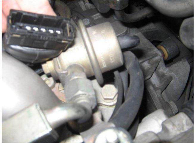
Dévisser la vis du collier de maintien du débitmètre [ cliquet + douille de 7 avec ou sans rallonge suivant la position de la vis)
