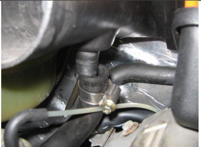
Remettre les tubes d'arrivée d'air.
