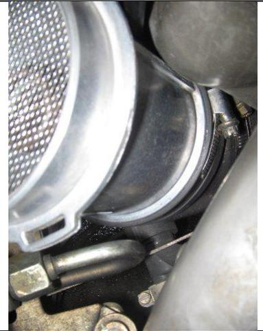
Une fois le collier largement ouvert, tirer verticalement sur le débitmètre pour le retirer du caoutchouc qui le maintient.
