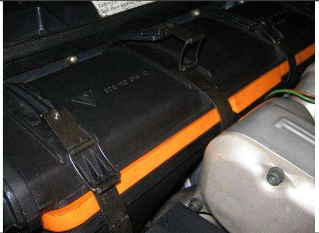
Dévisser les deux écrous de retenue de la partie basse de la boîte à air [cliquet + douille de 10mm + rallonge].
